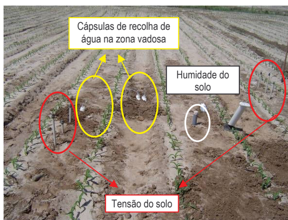
Fig. 11 - Dispositivos de medição de parâmetros na zona vadosa do solo em 2007
