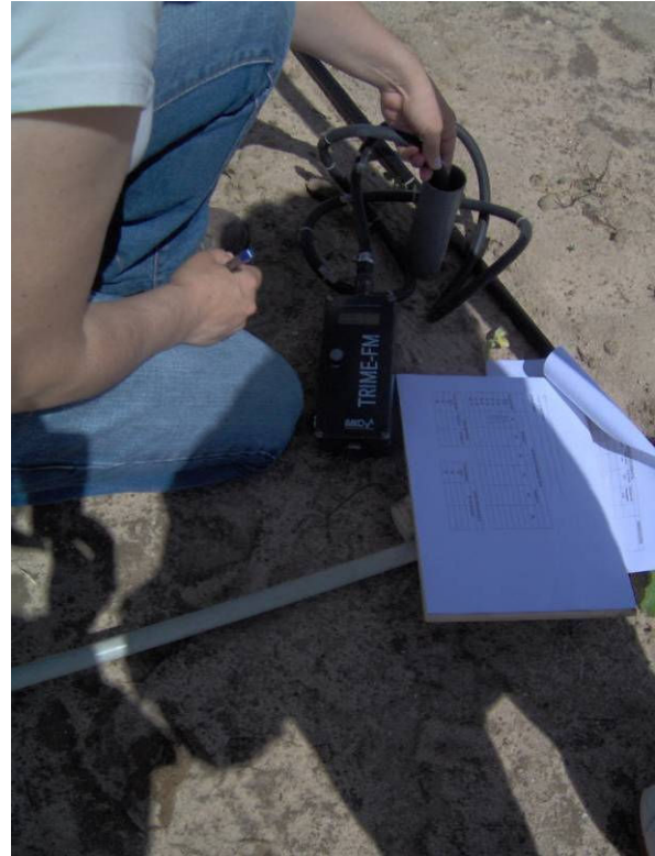
Fig. 6 - Aspecto da medição da humidade do solo
