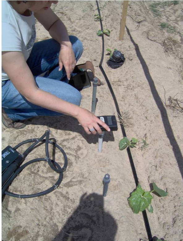
Fig. 5 - Aspecto da medição da tensão do solo
