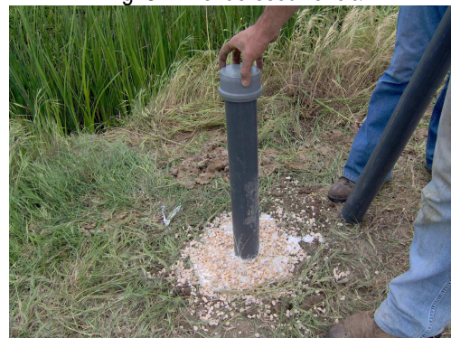
Fig. 5 - Piezómetro para amostragem de água subterrânea
