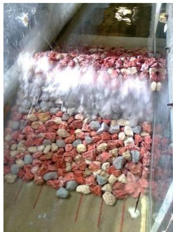
Figura 4.1 - Série de ensaios A. Aspecto da rebentação sobre o talude do quebra-mar
