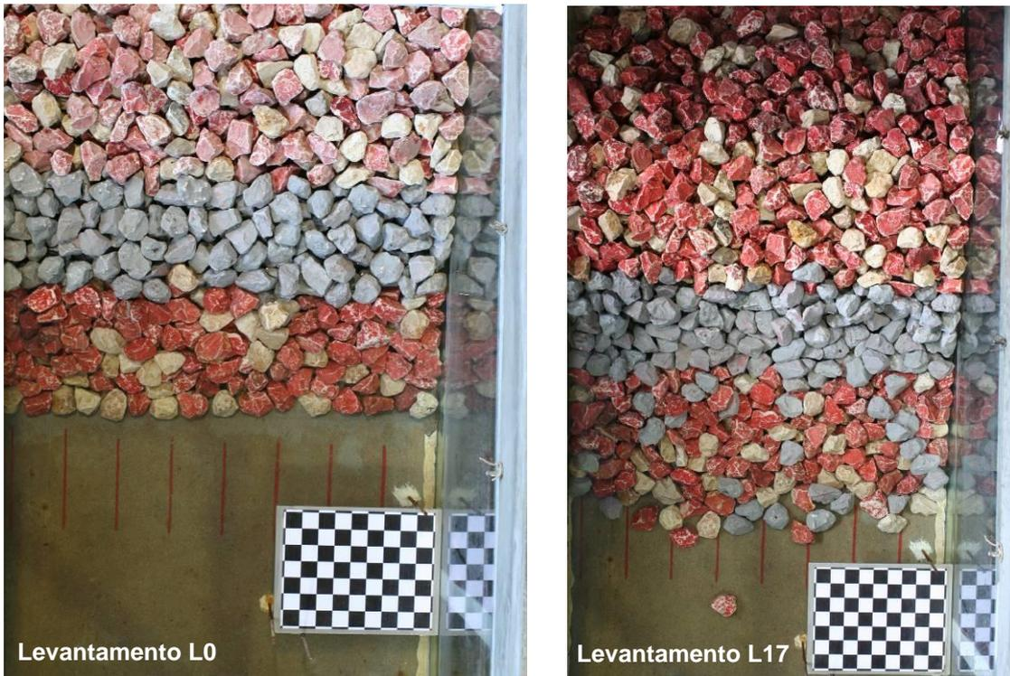
Figura A4.2 - Série de ensaios B. Aspecto do talude do quebra-mar no início e no final da série de ensaios respectivamente
