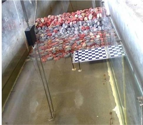
Figura 3.7 - Sonda mais próxima da estrutura
