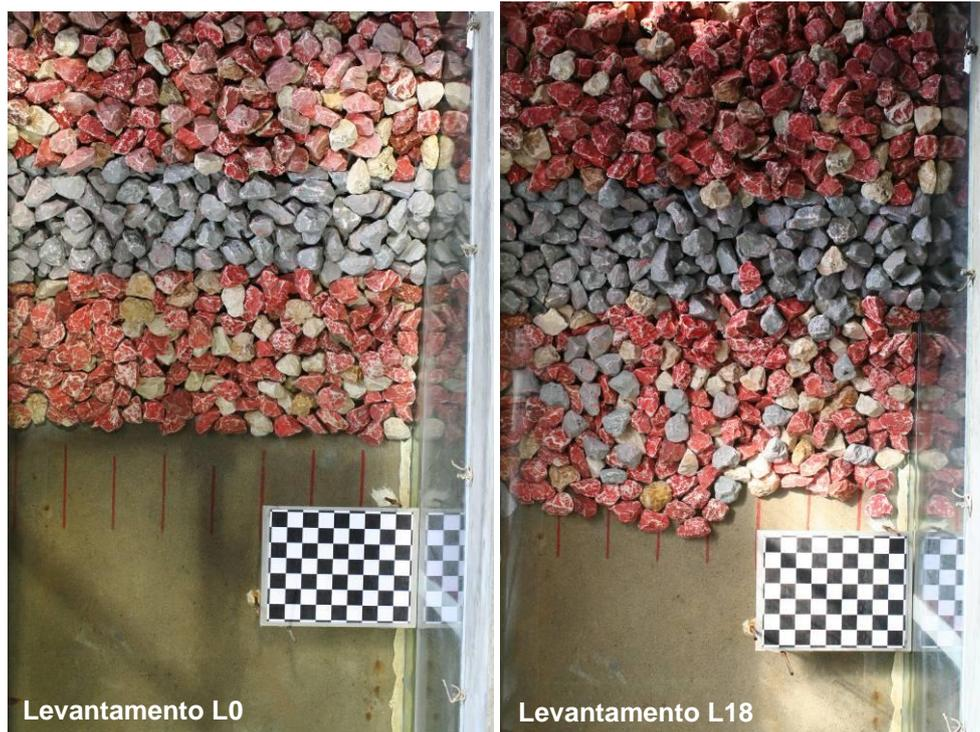
Figura A4.3 - Série de ensaios C. Aspecto do talude do quebra-mar no início e no final da série de ensaios respectivamente
