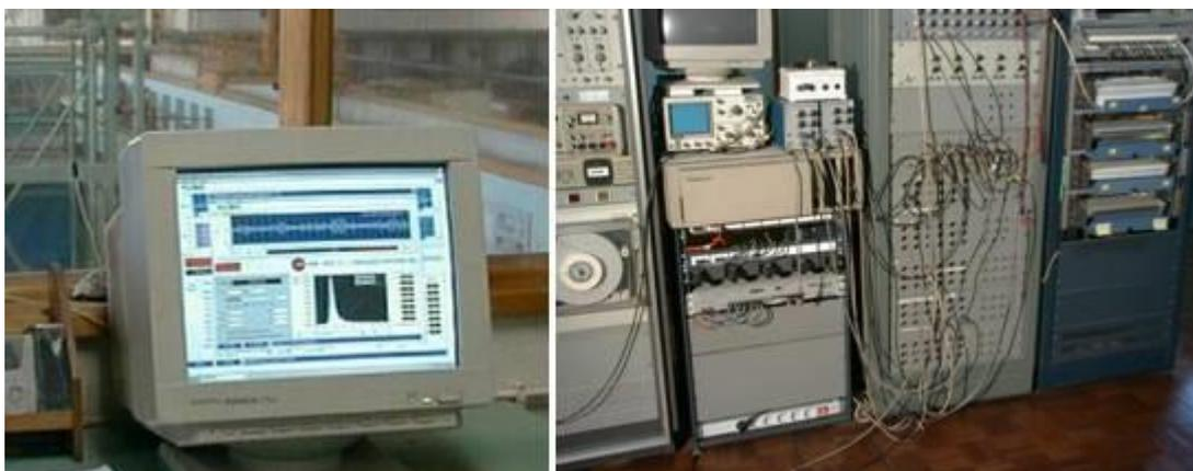
Figura 3.8 - Equipamento informático utilizado na geração de agitação e aquisição de dados
