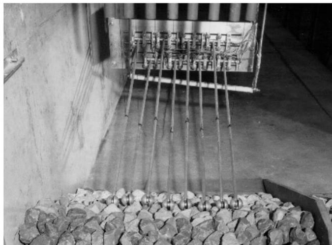
Figura 3.12 - Perfilador utilizado por Melby na medição do dano do manto protector de quebra-mares de taludes (Melby, 1999)
