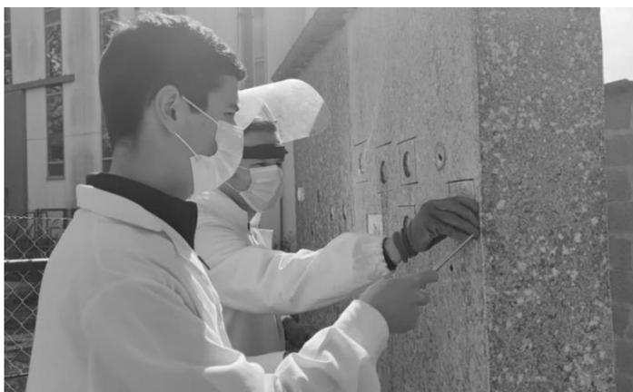
Figura 5. Preparação do murete de ETICS para posterior aplicação dos produtos de proteção estudados.
