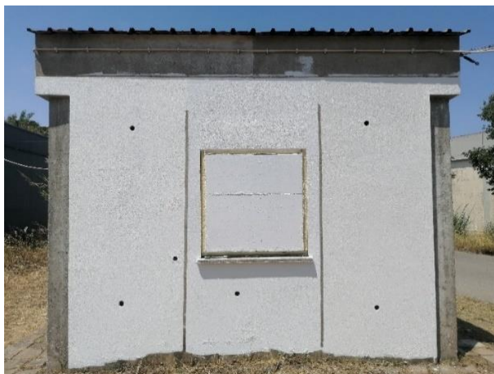
Figura 3.14 — Parede sul exterior com diferentes sistemas de pintura: da esquerda para a direita, com a tinta térmica 1 (PrN+BrT1), a tinta convencional (PrN+BrC) e a tinta térmica 3 (PrT+BrT3).
