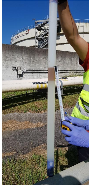
Figura 4.15 – LNAPL presentes no piezómetro 5001-MW08, em julho de 2023
