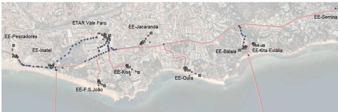
Fig. 1. Sistema interceptor, elevatório e de tratamento.
