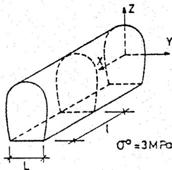
Fig. 18 - Caverna de uma central hidroelétrica.
