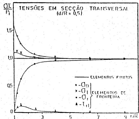
Fig. 6 - Túnel circular. Tensões e deslocamentos em secções transversais.
