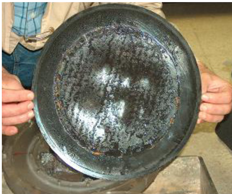
Figura 6 – Aspecto da geomembrana em contacto com o GCL no final do Ensaio nº 9.
