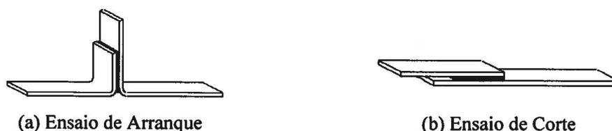
Figura 3 – Esquema dos ensaios destrutivos
