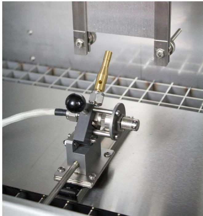
Figura 2.4 – Imagem de um queimador instalado no suporte de deslocação próximo do suporte de provetes
