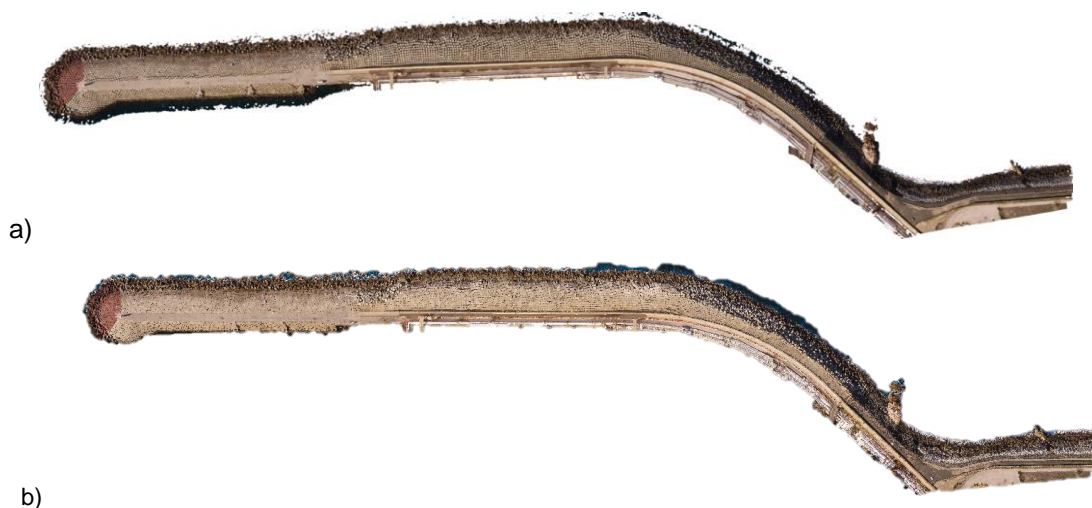
Figura 7. Quebra-mar oeste: a) ortomosaico; b) Nuvem de pontos
