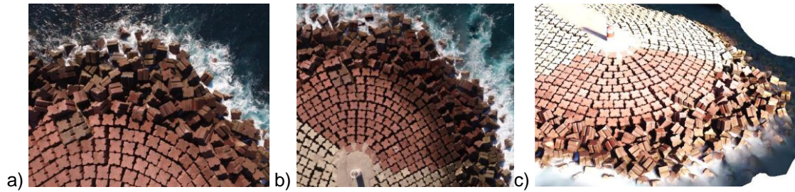
Figura 8 – Quebra-mar oeste: a) Foto aérea (cabeça); b) Pormenor do ortomosaico (cabeça); c) Modelo numérico (cabeça) de 2020 na forma de malha ( mesh )
