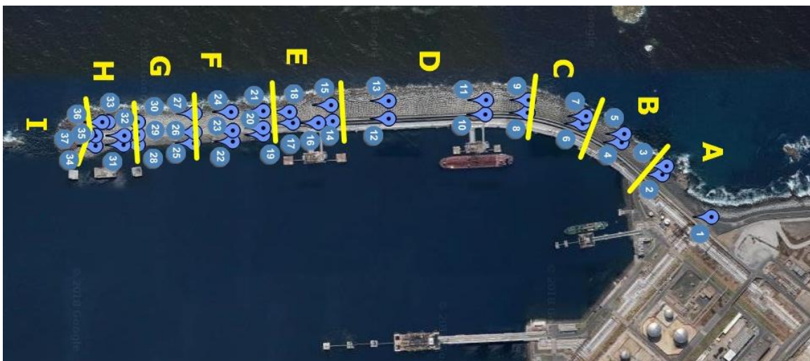
Figura 4. Porto de Sines. Divisão em troços e pontos de referência no quebra-mar oeste
