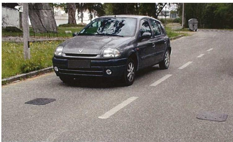
Figura 2.1 – Exemplo de colocação dos sensores eletromagnéticos
