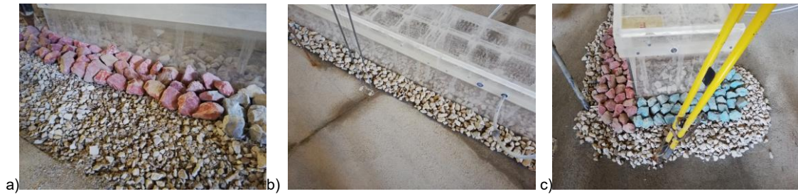
Figura 10. Fase 2. Solução melhorada. Modificação do peso do enrocamento de proteção na base da cortina de estaca-prancha.
