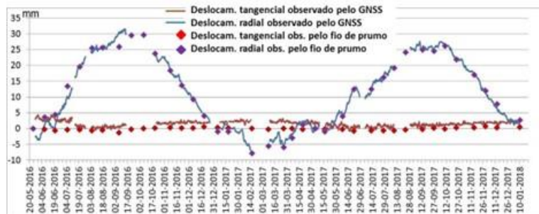
Figura 8. A comparação entre os deslocamentos observados pelo fio de prumo, na base de coordenómetro de FP3, e os deslocamentos observados pelo GNSS, nas componentes horizontais, na estação FP3M da barragem do Baixo Sabor. A linha castanha são as médias móveis dos deslocamentos observados pelo GNSS no sentido tangencial; a linha azul são as médias móveis dos deslocamentos observados pelo GNSS no sentido radial; os losangos vermelhos são os deslocamentos observados pelo fio de prumo, no sentido tangencial; os losangos azuis são os deslocamentos observados pelo fio de prumo, no sentido radial.
