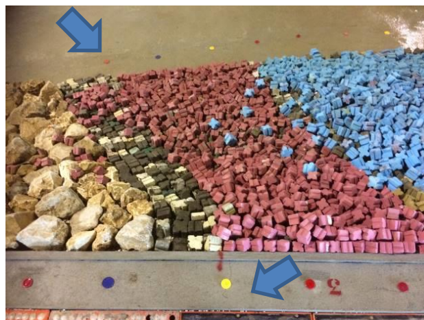
Figura 7. Pontos de controlo usados para georreferenciar as nuvens de pontos.
