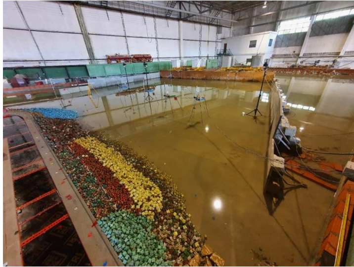
Figura 1. Aspeto do tanque utilizado para construção e ensaios do modelo físico de Ponta Delgada nas instalações experimentais do Pavilhão de Hidráulica Marítima do LNEC.
