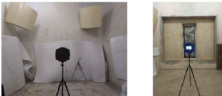
Figura 1 – Câmara recetora (foto da esquerda) e provete em ensaio (porta de vidro) colocada entre as câmaras.
