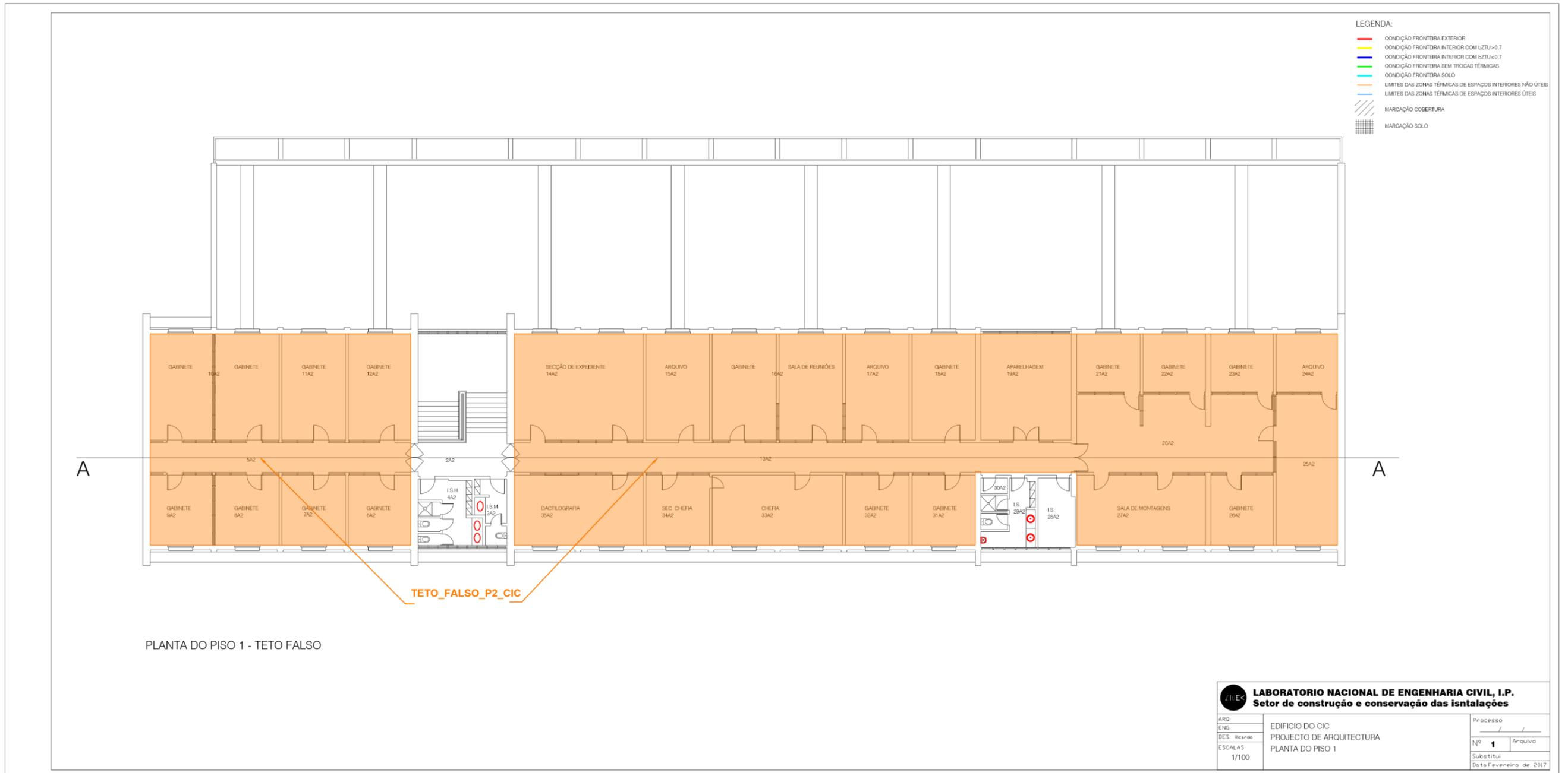
Figura – Planta do 1º Piso – Teto Falso: Identificação das zonas térmicas
