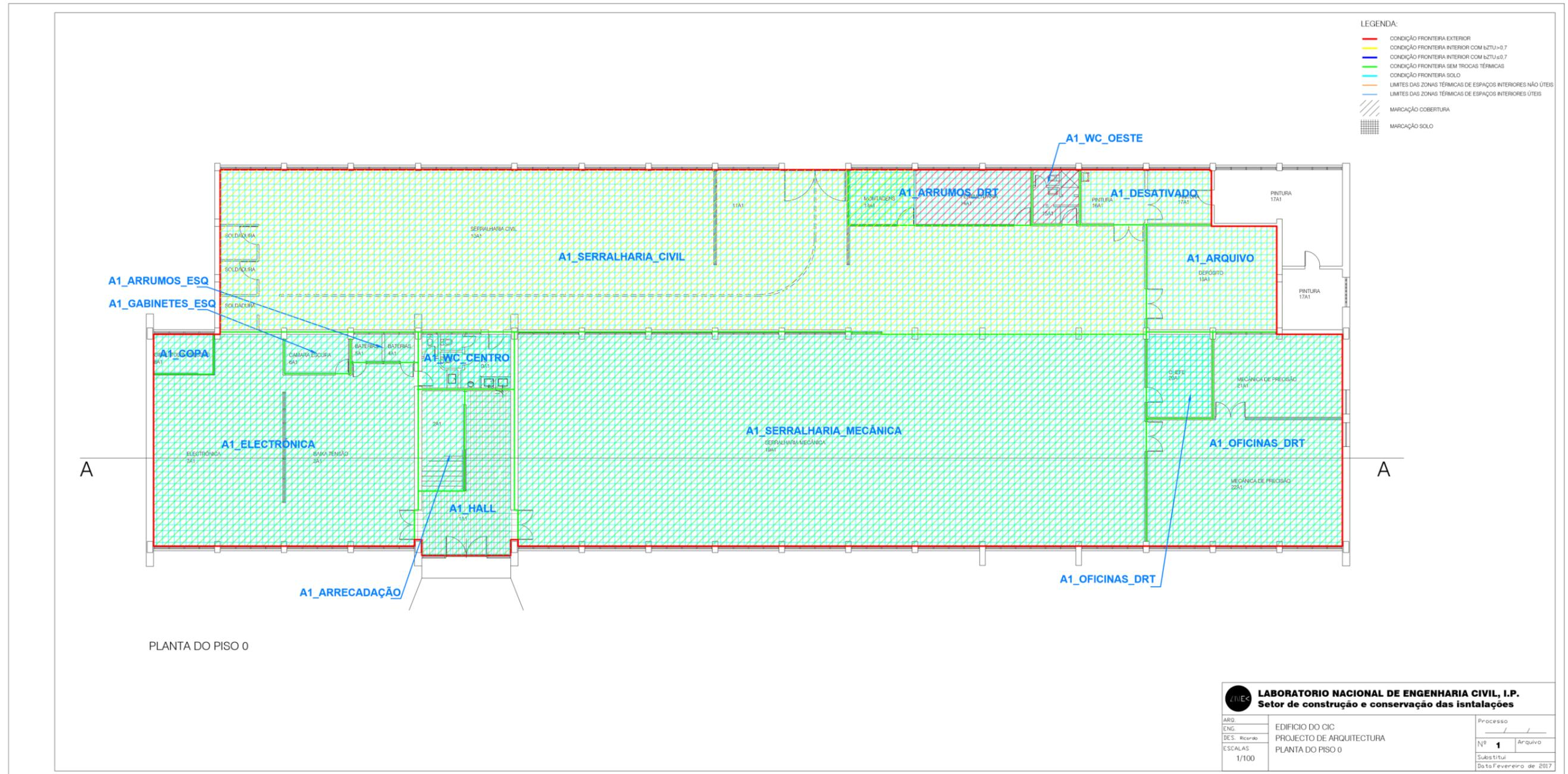
Figura – Planta do Piso 0: Identificação das zonas térmicas
