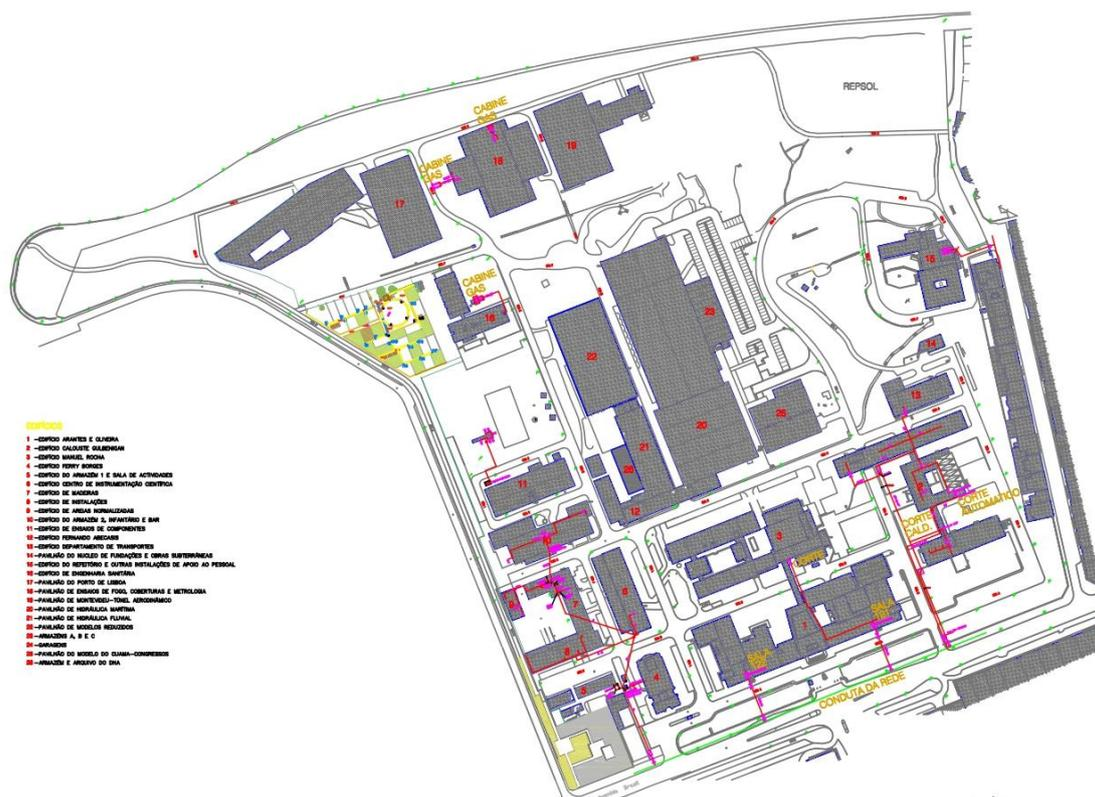
Figura – Rede de distribuição de gás natural no LNEC
