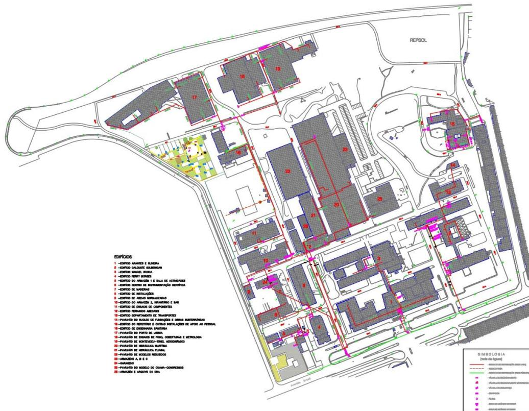
Figura – Rede de distribuição de água no LNEC
