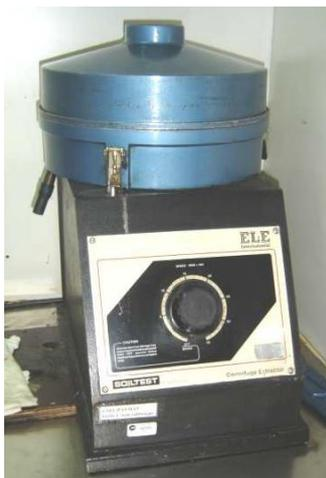
Figura 2.1 – Equipamento de centrifugação utilizado pela UPAVMAT
