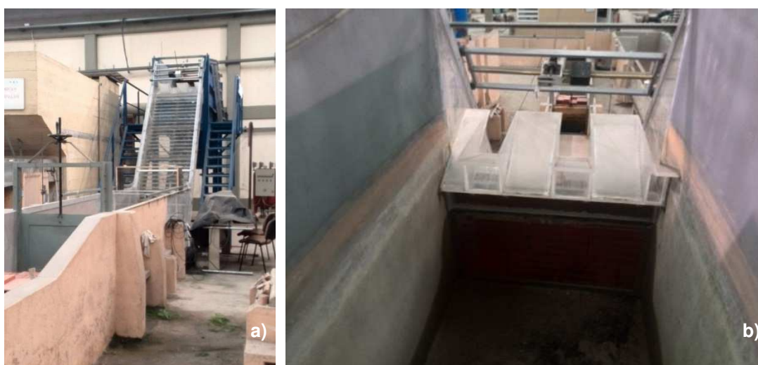
Figura 4.18 | Instalação experimental para estudo de novas soleiras: a) vista de jusante e b) aspeto geral da soleira descarregadora do tipo PKW
