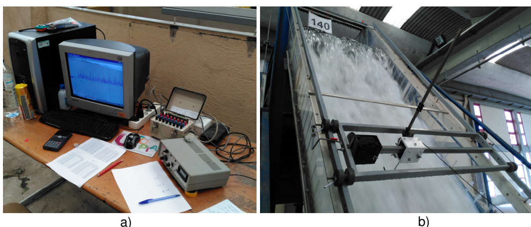
Figura 3.13 | Medição da concentração de ar: a) aparelhagem utilizada para a aquisição digital das concentrações de ar; b) sonda de ar em funcionamento
