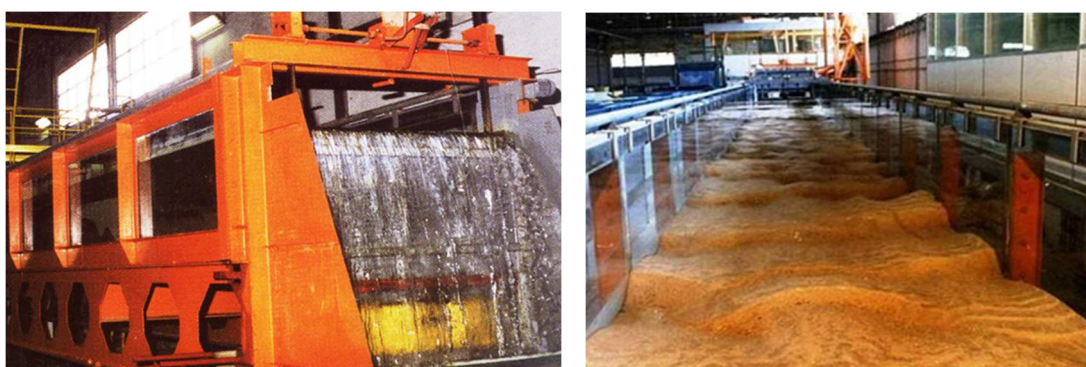
Figura 3.22 | Aspeto geral do Canal de Inclinação Variável
