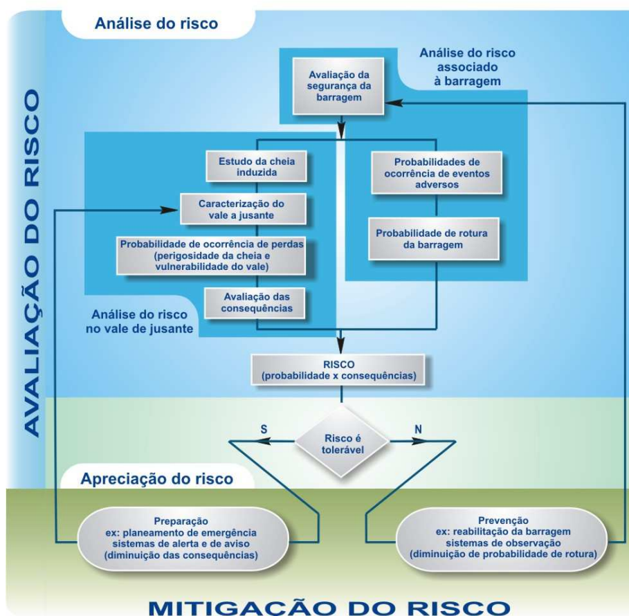
Figura 4.1 | Gestão do risco nos vales a jusante de barragens (Viseu, 2016)
