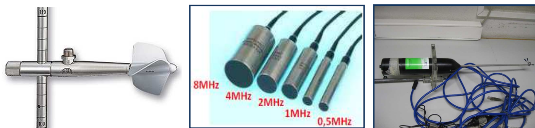
Figura 3.11 | Medição de velocidades: a) com molinete OTT; b) aspeto de uma sonda UVP
