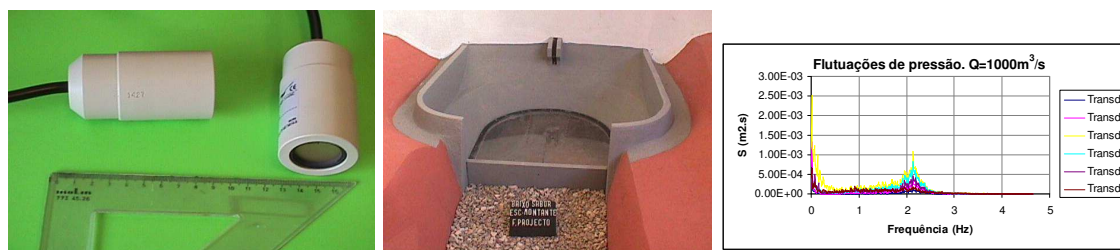
Figura 3.10 | Medição de pressões: a) sensores Keller; b) medição no modelo físico da bacia de impacto do descarregador da barragem do Sabor; c) função de densidade espectral das flutuações de pressão
