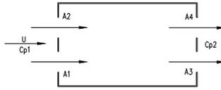
Figura 7: Ventilação cruzada devida à acção do vento, com duas aberturas por fachada
