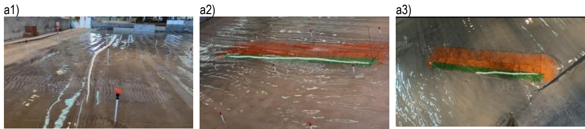
Figura 6.1 – Ensaio físicos: variação da superfície livre e posição da linha de rebentação. a1) sem QMD; a2) QMD 0°; a3) QMD 45°. Agitação regular: T=12 s; H_s=2,0 m, NMM
