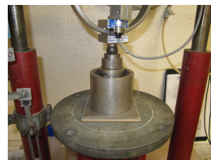
Fig. 1 – Equipamento desenvolvido: a) câmaras de humidade relativa, b) equipamento para realização de ensaios de esmagamento.
