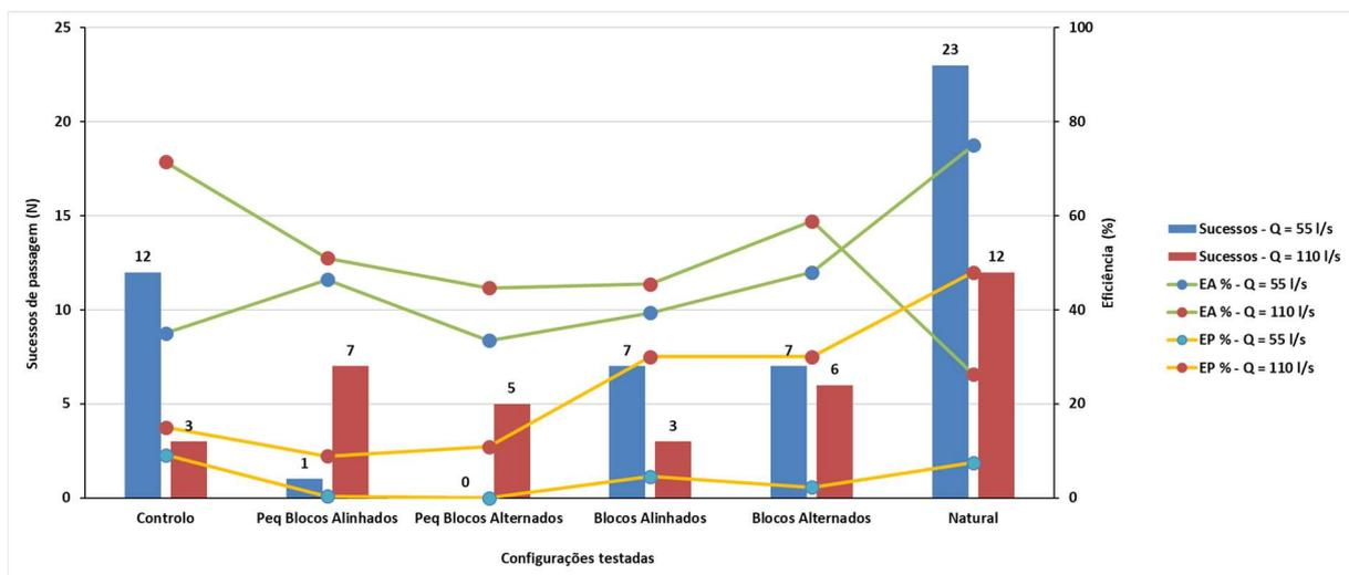
Fig. 2. Resultados da aplicação de diferentes substratos a açudes rampeados. EA%, eficiência de atração; EP%, eficiência de passagem.
