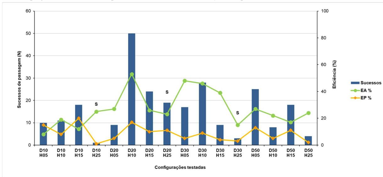
Fig. 1. Resultados dos ensaios realizados com os açudes de faces verticais (Q=50 l/s). EA%, percentagem de eficiência de atração; EP%, percentagem de eficiência de passagem. Nas configurações assinaladas com S, os sucessos foram alcançados por salto.
