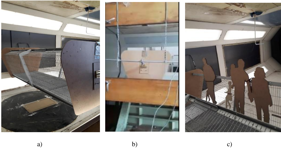
Figura 6 - O modelo instalado no túnel de vento
