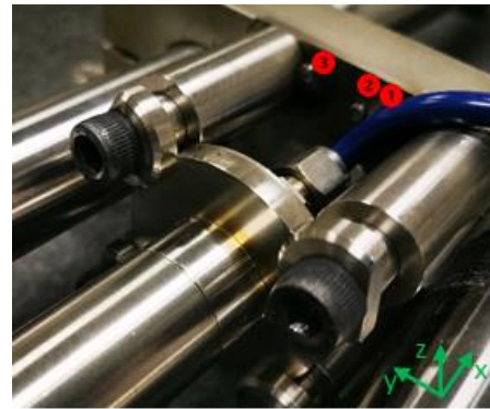
Figura 3.13 – Pontos medidos na superfície da fixação da extremidade fixa do extensómetro
