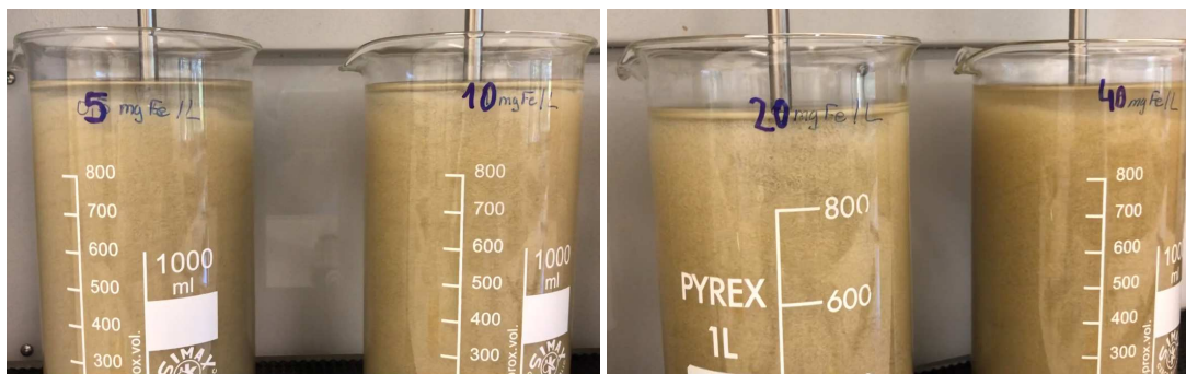
Figura 3.4 – Etapa de coagulação/floculação com diferentes concentrações de cloreto férrico (5 mg/L a 40 mg/L \text{FeCl}_3 )
