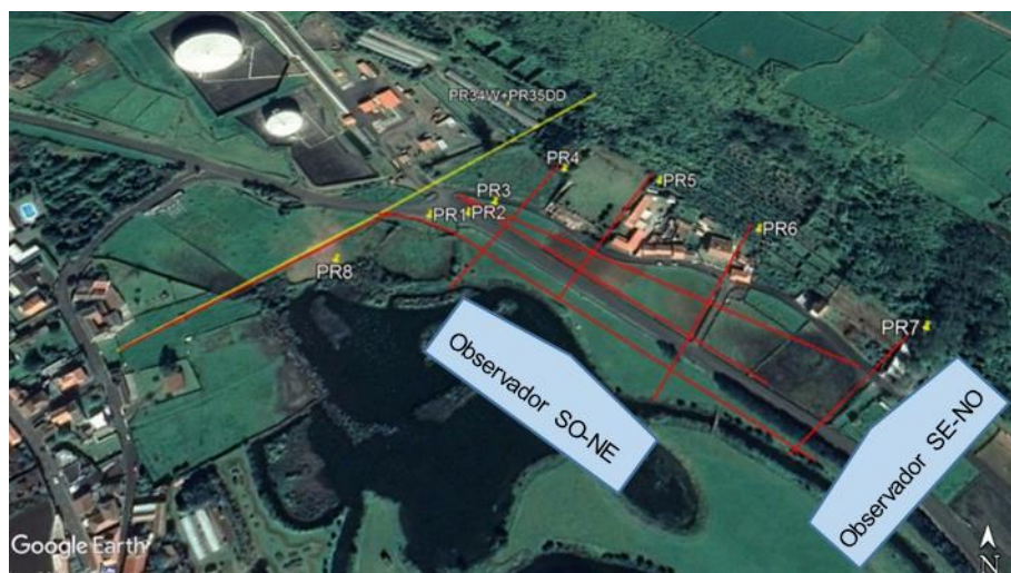
Figura 3.5 – Ilustração do posicionamento de um observador para análise dos modelos de resistividade elétrica obtidos em cada perfil
