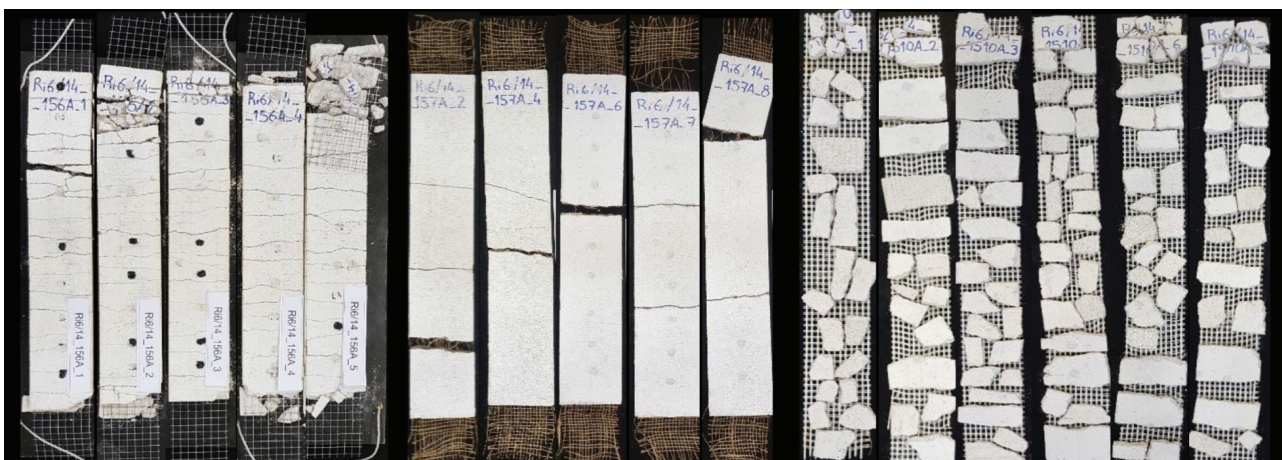
Figura 8 Modos de rotura dos revestimentos armados constituídos por argamassa à base de cal aérea e as diversas redes em estudo
