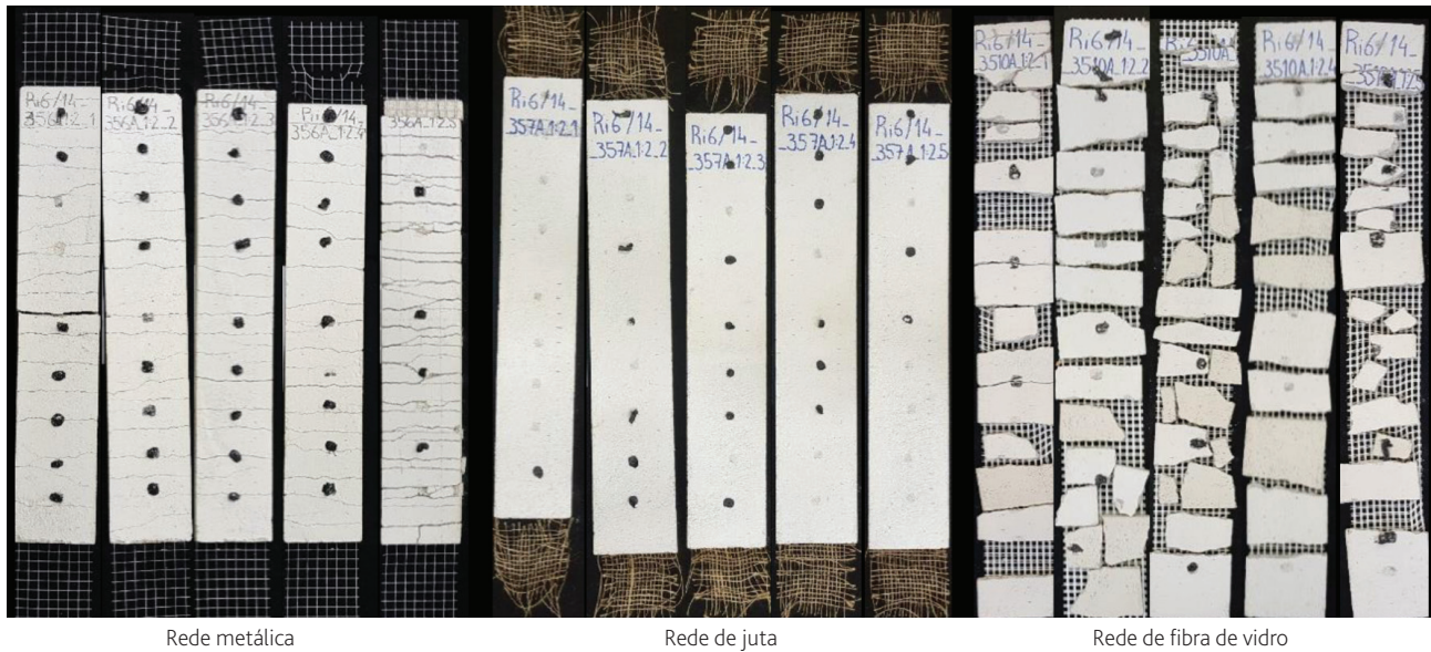
Figura 10 Modos de rotura dos revestimentos armados constituídos por argamassa à base de cal hidráulica natural ao traço 1:2 e as diversas redes em estudo
