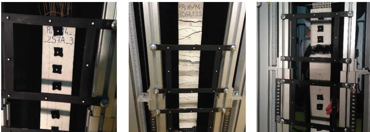
Figura 7 Exemplo de alguns modos de rotura dos revestimentos armados nos ensaios de tração
