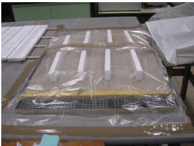
Figura 2 Cura dos provetes de revestimento armado
