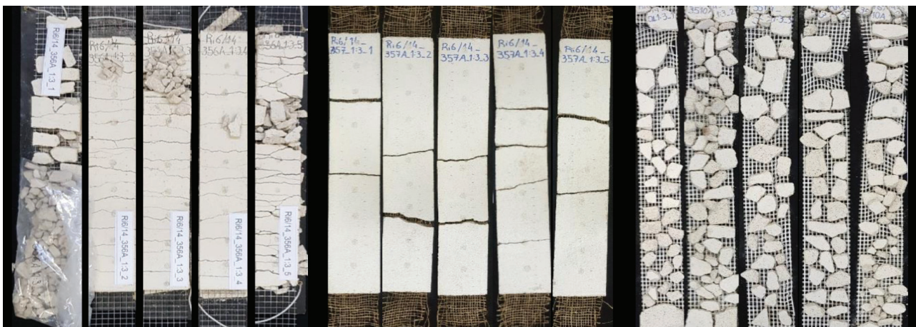
Figura 9 Modos de rotura dos revestimentos armados constituídos por argamassa à base de cal hidráulica natural ao traço 1:3 e as diversas redes em estudo
