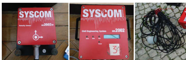
Figura 3 Equipamento de medição constituído por sensor de velocidades, aquisição de dados, antena GPS, respetivamente
