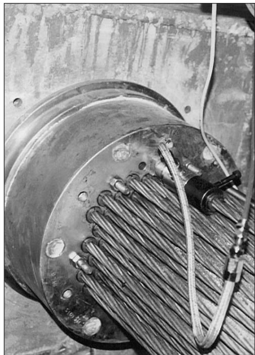
**Figura 8:** Célula de carga para medição da força instalada nos tirantes.
