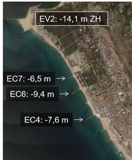
Figura 3.3 – Valores máximos observados das erosões localizadas na vizinhança dos esporões da Costa da Caparica (EC1-EC7) e da Cova do Vapor (EV1-EV2)
