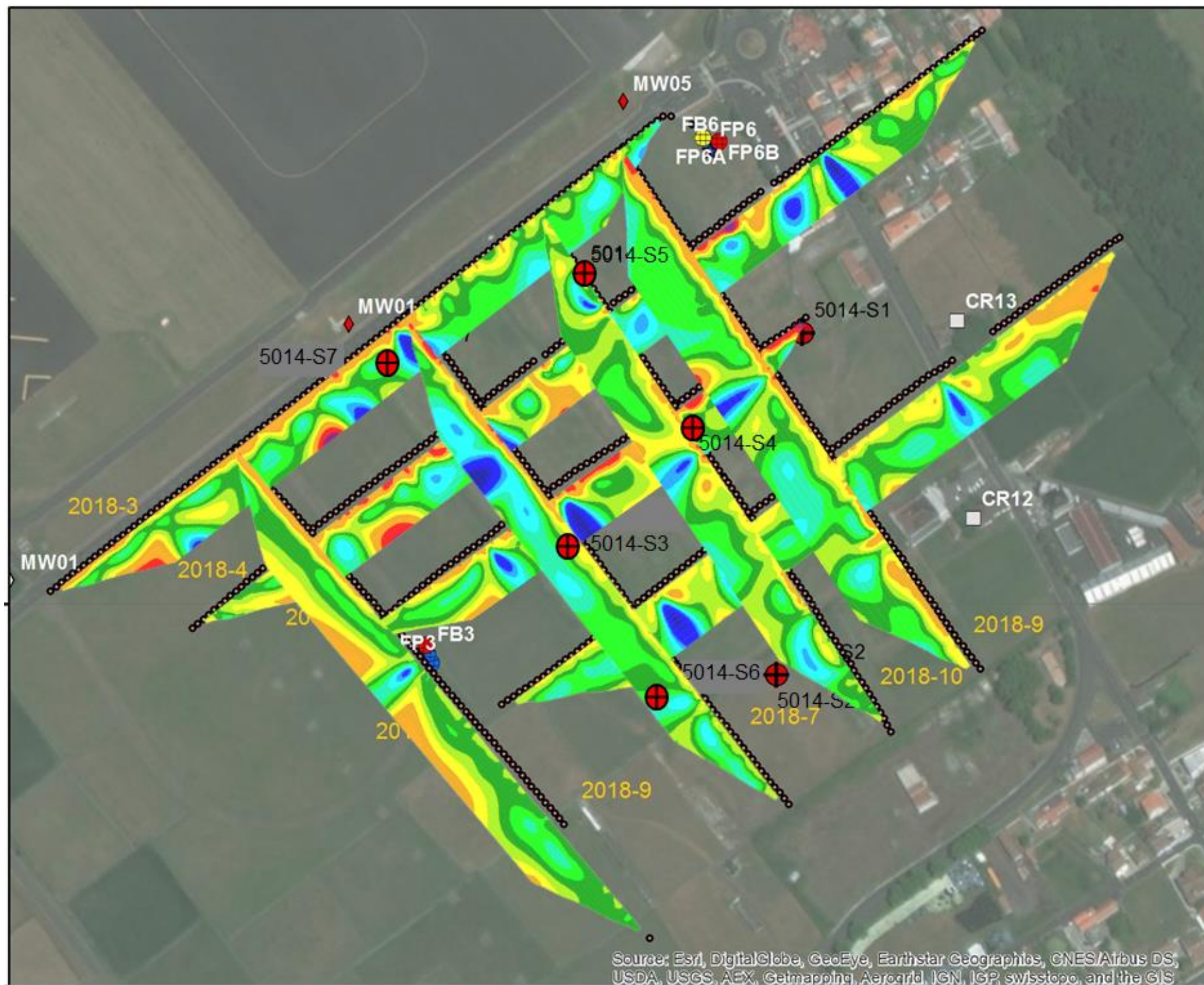
Figura 4.49 – Implantação aproximada de todos os modelos de resistividade obtidos na planta de localização dos trabalhos realizados no Site 5014
