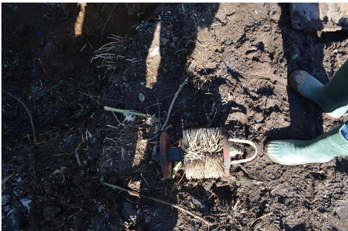
Figura 3.10 – Pormenor do *brush pig* (escova) usado nas operações de limpeza do *pipeline* do Cabrito
