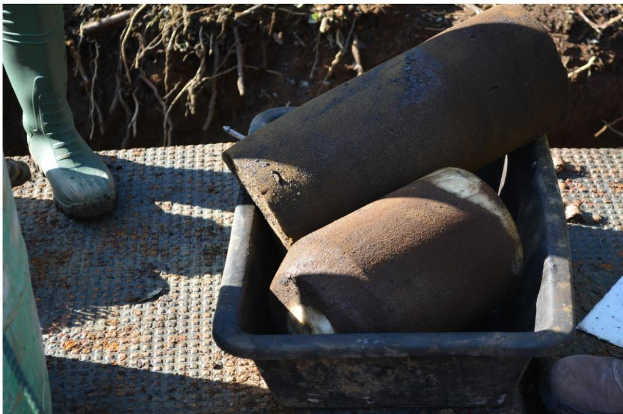
Figura 3.9 – Pormenor do *foam pig* (esponja) usado nas operações de limpeza do *pipeline* do Cabrito
