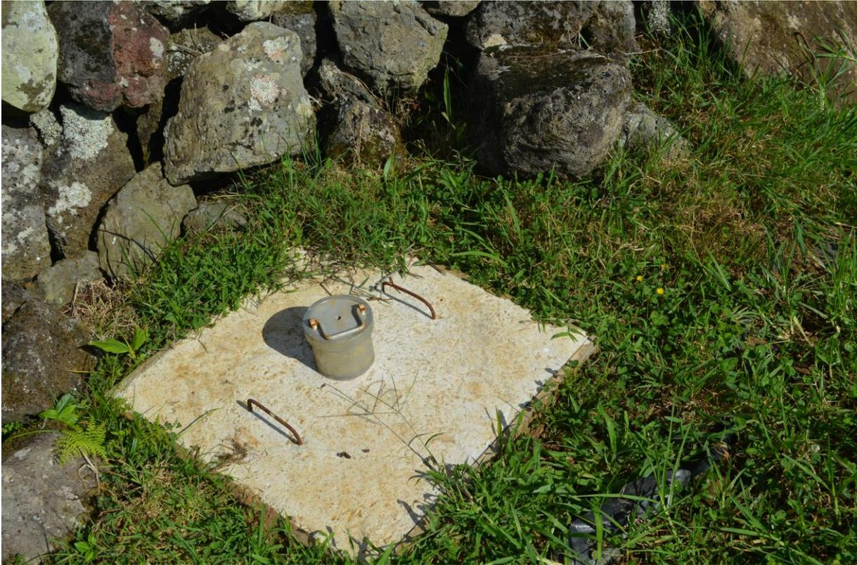
Figura 3.103 – Pormenor da tampa de proteção de um dos piezómetros instalados na área afetada pelo derrame de combustível
