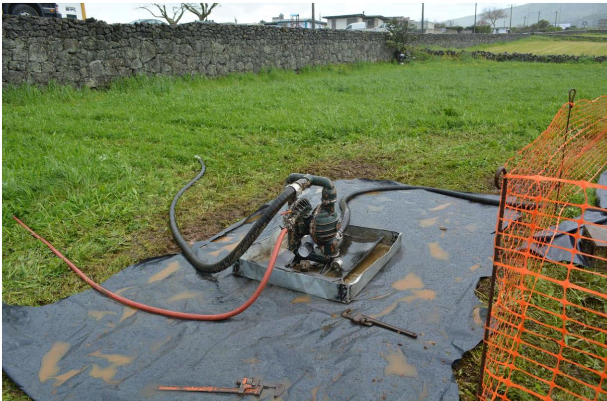
Figura 3.61 – Pormenor da bomba utilizada na operação de extração do combustível do *pipeline*
