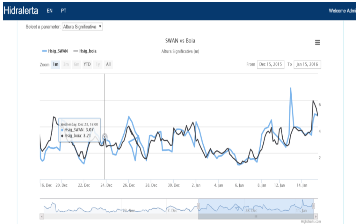
Figura 3.13 – Validação dos modelos numéricos com os dados da boia ondógrafo em tempo real
