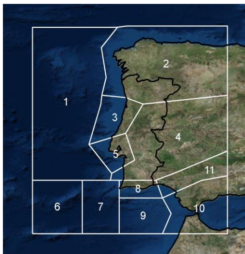
Figura 2.1 – Zonas Sísmogénicas consideradas no modelo EC8 (adaptado de Campos Costa et al. , 2008)
