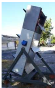
Figura 4 – Vista global do modelo seccional montado no suporte articulado.
