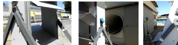
Figura 5 – Pormenor do modelo seccional, saída do túnel de vento de jato livre do LNEC e anemómetro de ultra-sons 2D.
