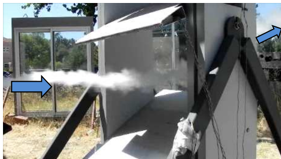
Figura 11 – Visualização do escoamento com injeção de fumo para \alpha=30^\circ . As setas assinalam a direção do fumo a montante e a jusante da cascata.
