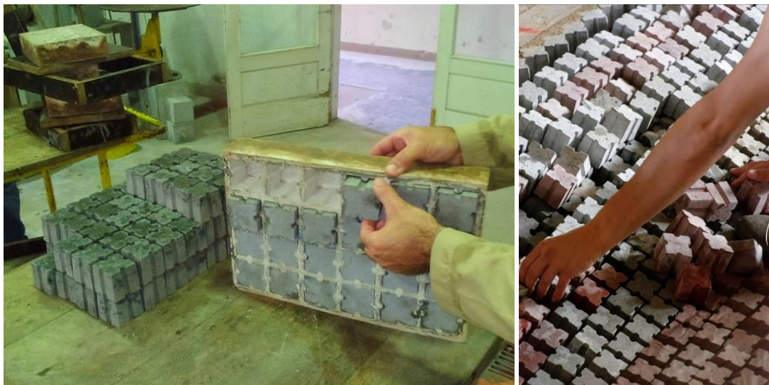
Figura 7 – Desmoldagem e colocação no modelo dos cubos Antifer dos blocos adensados correspondentes a um peso de 695 kN.
