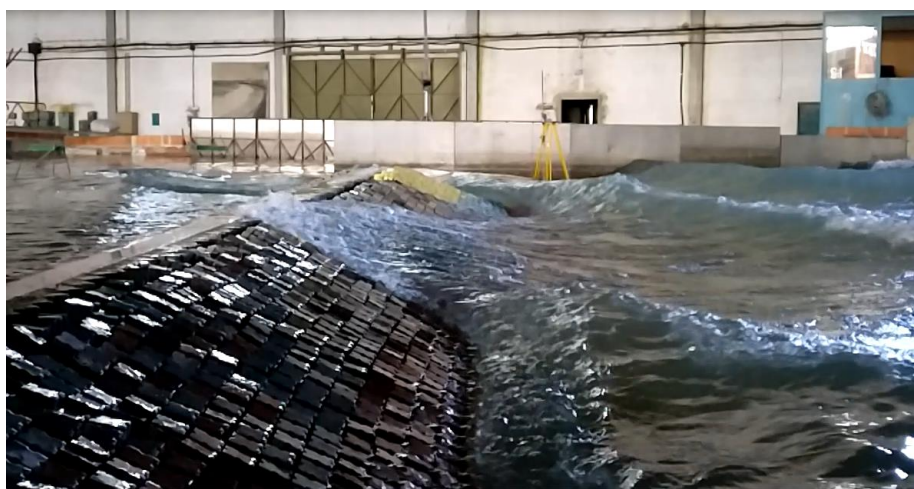
Figura 20 - Aspecto dos galgamentos e do espraiamento e refluxo observados durante um ensaio com rumo SW, nível de maré de 0.0 m (ZH), T_p = 20 s e H_s = 10 m
