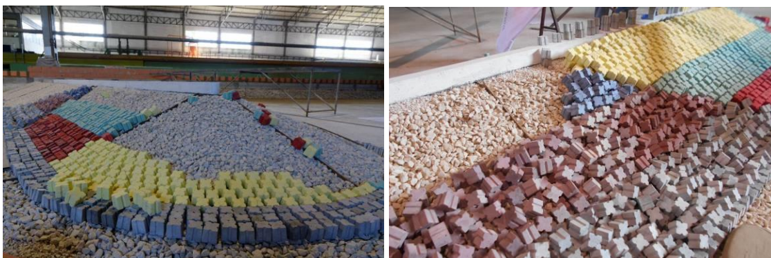
Figura 8 – Aspeto da construção do modelo. Colocação de cubos Antifer.
