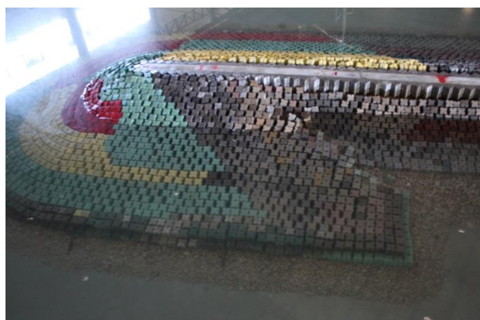
Figura 21 – Aspecto do remate após os ensaios com rumo SW, PM, T_p=20 s e H_s=8 m
