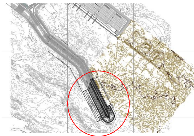
Figura 2 – Porto de Sines. Planta do porto considerando o prolongamento do molhe leste e a expansão do Terminal XXI (CONSULMAR, 2017) bem como a batimetria
