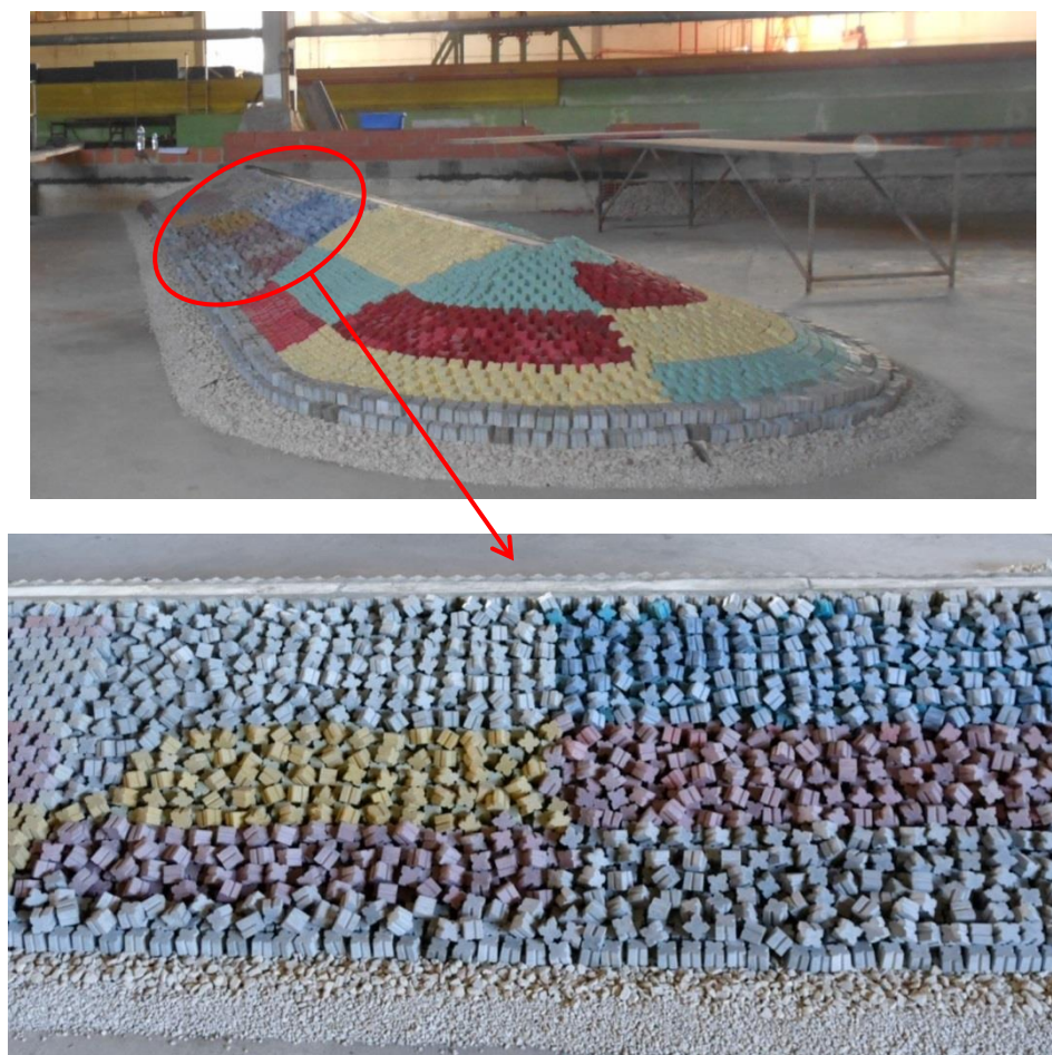
Figura 13 – Trecho do modelo onde os blocos foram colocados de modo semi-arrumado.
