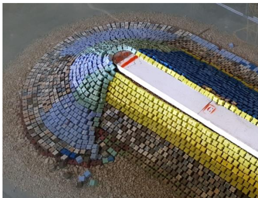
Figura 30 – Aspecto do modelo no final de um ensaio com nível de maré de Preia-mar e T_p=20 s
