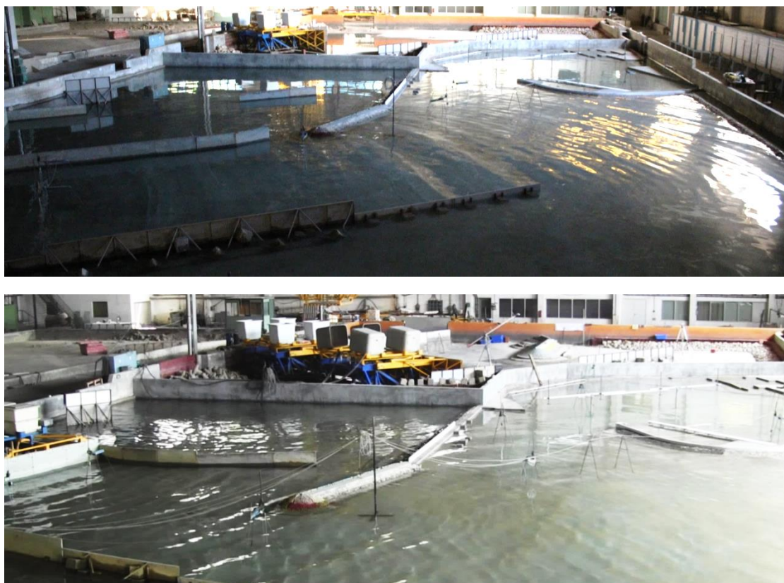
Figura 24 – Aspeto da agitação no ensaio com o rumo de SW (cima) e W (baixo)
