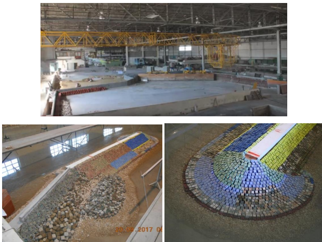
Figura 29 – Tanque de ondas (em cima). Aspeto do modelo após construção (em baixo)
