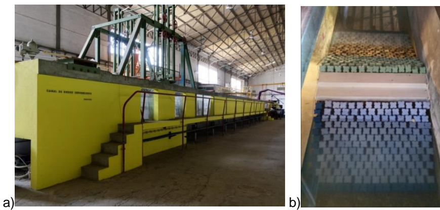
Figura 26 – a) Canal de ondas COI1; b) Aspeto do perfil após construção
