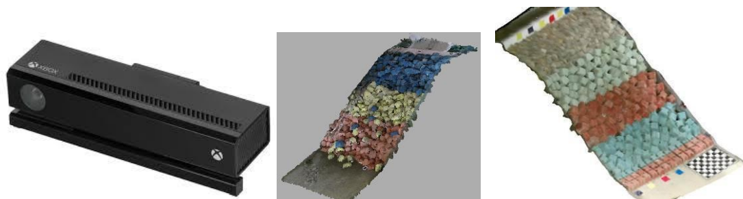
Figura 18 – a) Kinect sensor b) Modelos tridimensionais obtidos com Microsoft® Kinect® sensor application em levantamentos de ensaios em canal
