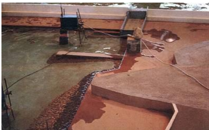
Figura 4 – Sobrelevação, com inundação dos terraplenos
