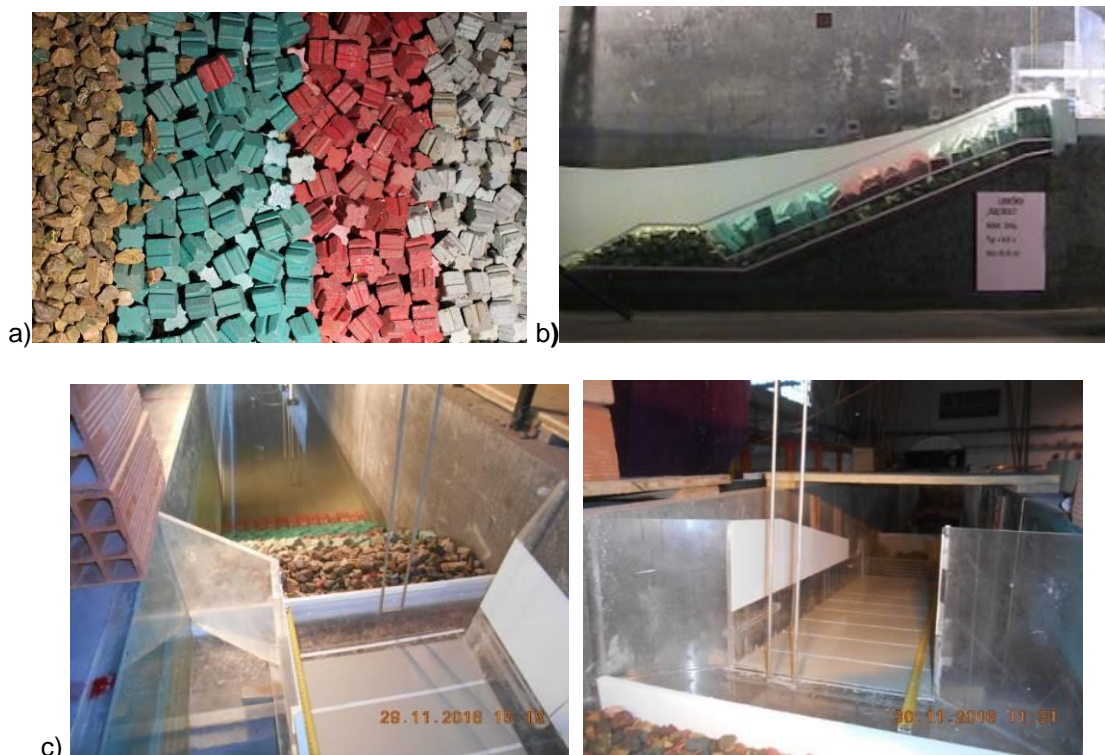
Figura 5 – Ensaio bidimensionais: a) Estabilidade; b) Avaliação qualitativa do galgamento; c) Descarregador, reservatório e balança para avaliação quantitativa do galgamento e da sua extensão
