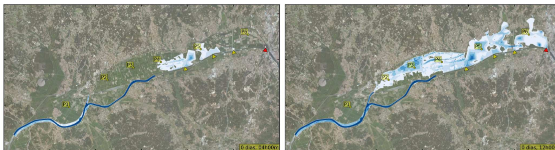
Figura 3. Progressão da inundação com a entrada em funcionamento das estruturas de descarga
