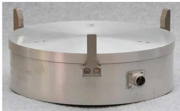
Figura 2.3 – Célula de carga do padrão de força com acessórios para ligação à placa de carga
