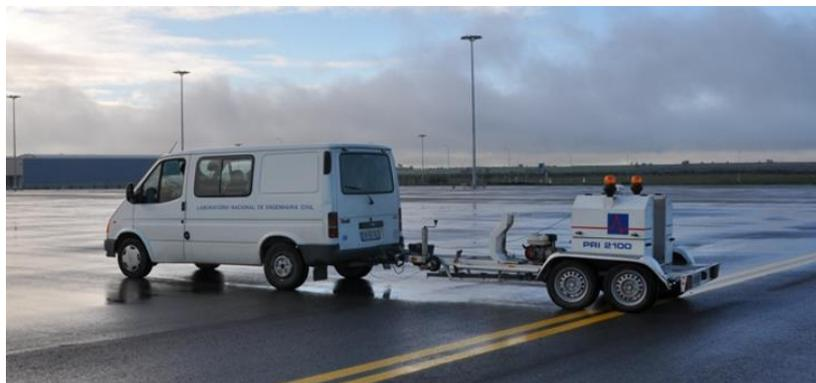
Figura 2.1 – Veículo para ensaio de pavimento aeroportuário com defletómetro de impacto
