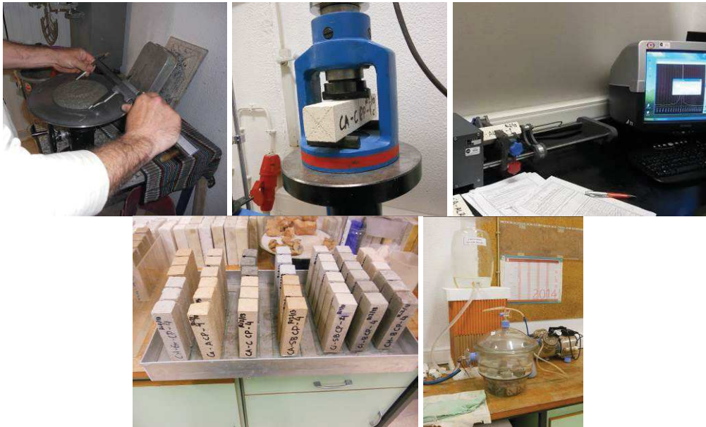
Figura 2: Aspetos da realização dos ensaios no estado fresco e endurecido para a avaliação das características físicas e mecânicas das argamassas
