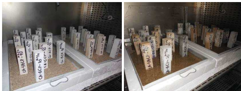
Figura 3: Aspeto dos provetes prismáticos de argamassa durante o ensaio de envelhecimento acelerado
