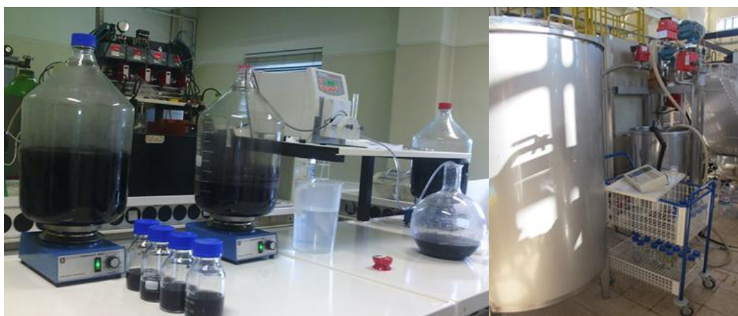
Figura 6. Ensaios de laboratório/piloto para otimizar condições de operação de PAC/MF
