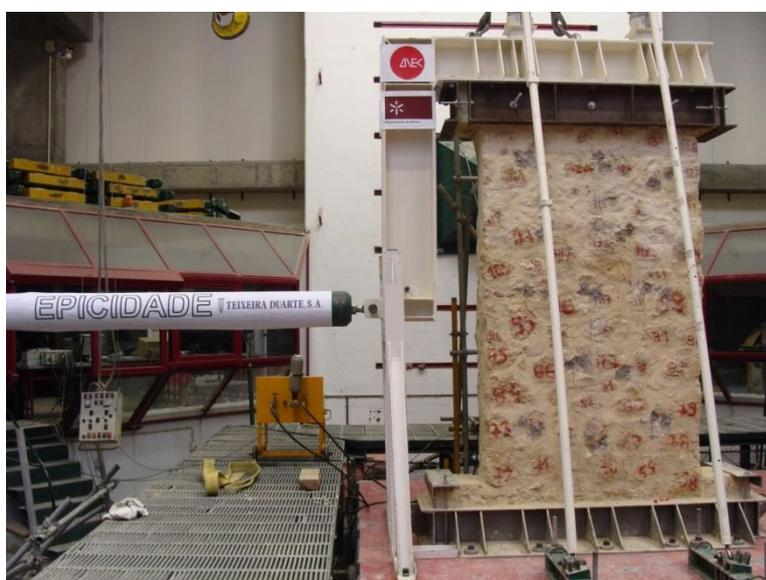
Figura 2: Vista geral do dispositivo de ensaio utilizado para ensaios de carregamento no plano de provetes representativos de nembos de edifícios de alvenaria de pedra calcária irregular.
