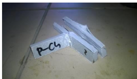
Figura 8: Modos de rotura parcial observado no ensaio de choque Charpy
