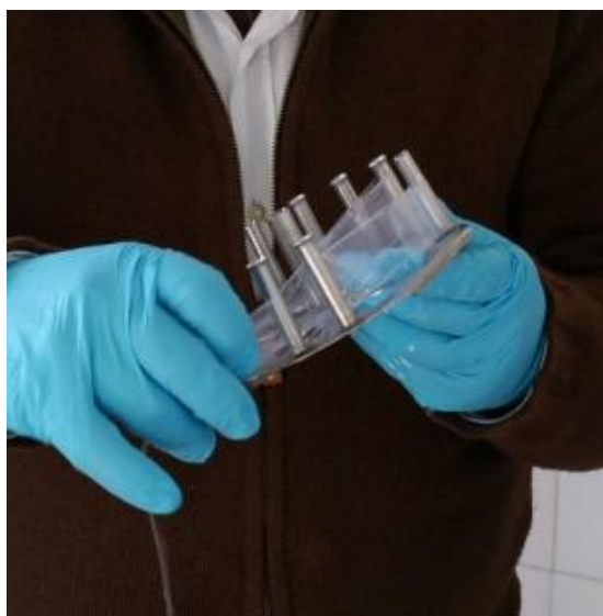
Figura 5.3 – Amostrador de Hidrocarbonetos Aromáticos Polinucleares (PAH) (Morais, 2016)
