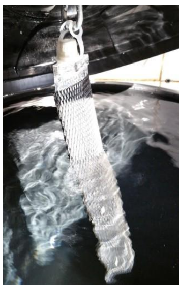
Figura 5.2 – Amostrador de Compostos Orgânicos Voláteis (VOC) (Morais, 2016)
