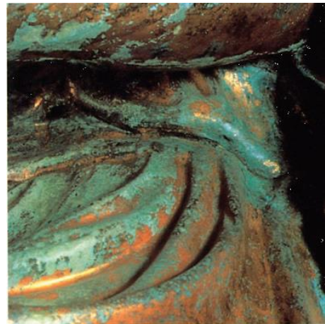
Danos na película de ouro de revestimento exterior de uma estátua por corrosão do substrato de bronze [Marabelli, 1994]
