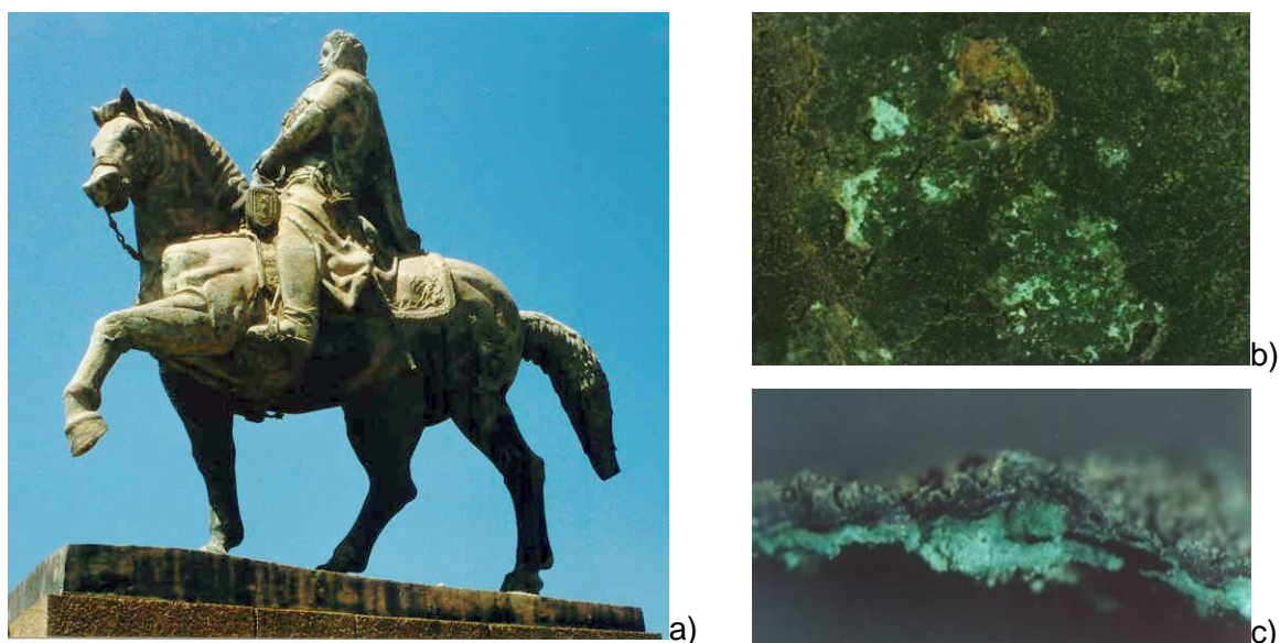
Figura 6: a) Aspeto geral das pátinas formadas em estátuas expostas em ambiente marinho; b) detalhe de uma zona da pátina com corrosão localizada por picadas (cloretos de cobre); c) detalhe da secção transversal da pátina com uma camada exterior acinzentada e uma camada interior verde
