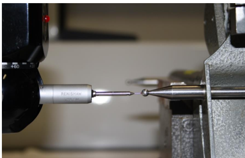
Figura 3.3 – Pormenor da medição dimensional da ponteira de contacto do alongâmetro
