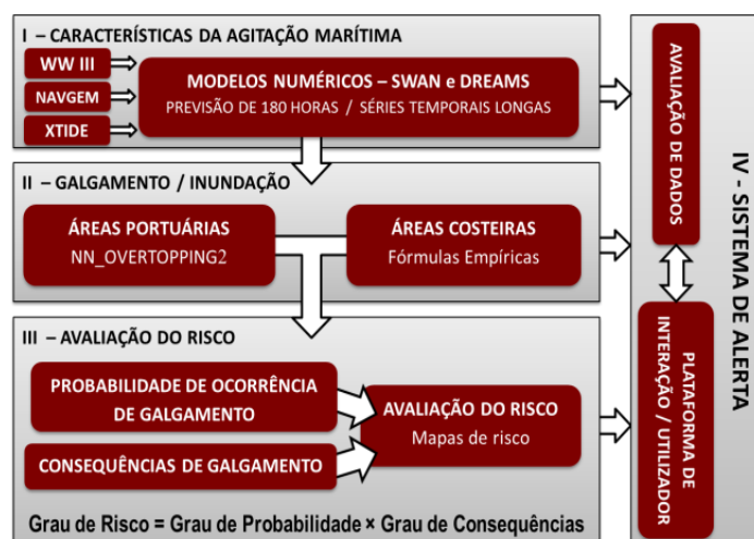
Figura 1. Esquema do sistema HIDRALERTA.
